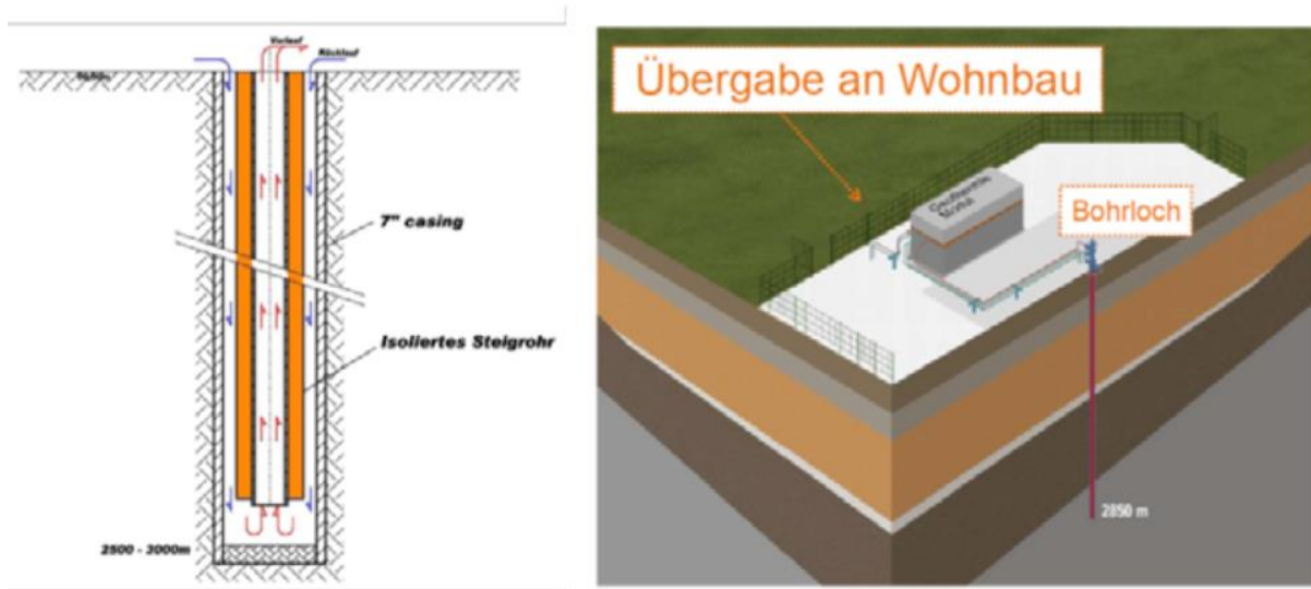
Abbildung 15: Beispiel einer Tiefen Erdwärmesonde (TEWS).
