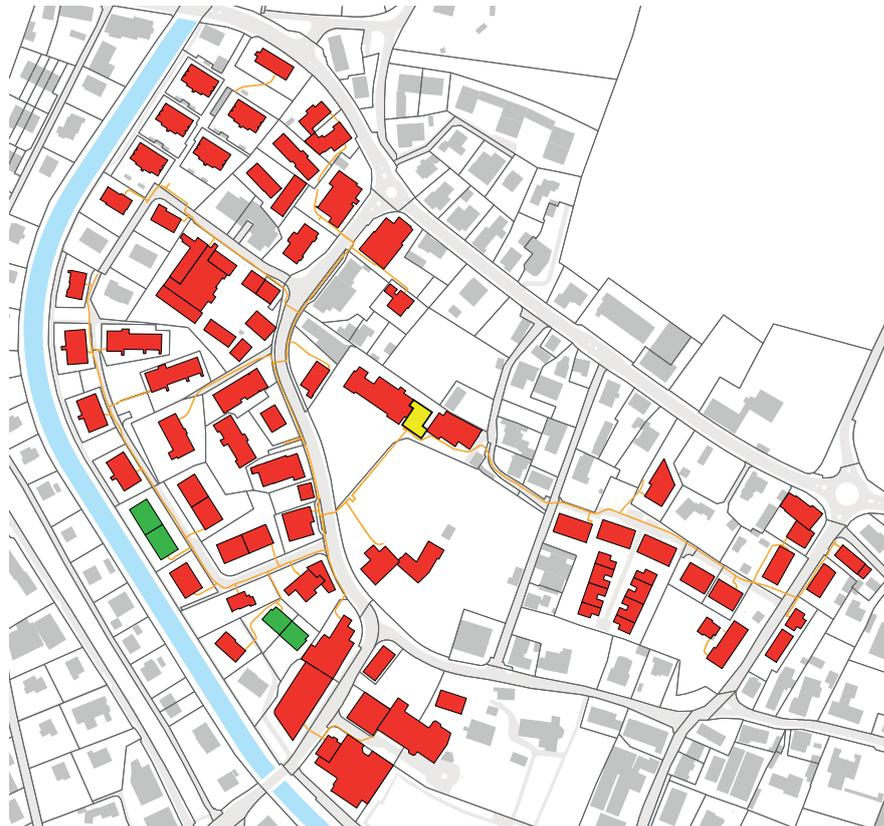
Abb. 32 Leitungsführung Wärmeverbund Dorf mit Heizzentrale (rot: angeschlossene Gebäude, grün: geplanter Anschluss, gelb: Heizzentrale; Quelle Energie Belp)
