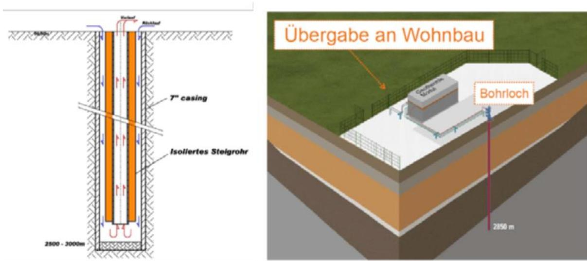
Abbildung 15: Beispiel einer Tiefen Erdwärmesonde (TEWS).
